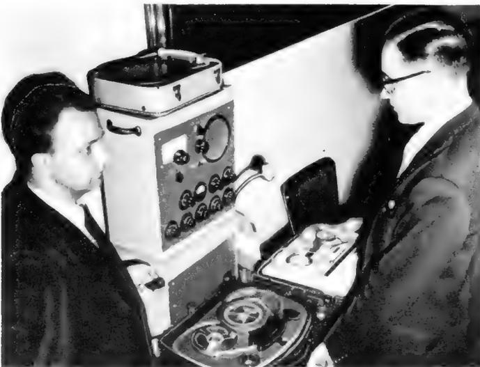
Nach FUNKSCHAU-Konstruktionsseiten gebaute Geräte der „Verstärkerserie 53“ beim Vertonen von Amateurfilmen. Im oberen Gehäuse: Rundfunk- und Abhörzusatz RAZ 52 mit dem Mischpult-Entzerrerverstärker MPV-E 10/7
