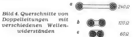
Bild 4. Querschnitte von Doppelleitungen mit verschiedenen Wellenwiderständen
